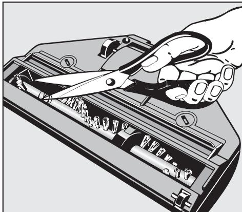
Om turboborsten är igensatt av hårt fastsittande smuts inuti eller är blockerad, kan du öppna den. Större föremål kan på så vis enkelt tas bort.
