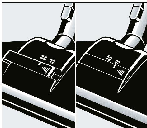
それ以外の状況では、吸引力を最大限に利用するため、風力調節スライドは閉じて使用してください（右図）。
