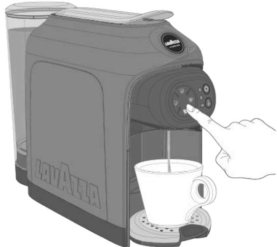
**!** Quando é selecionado um fornecimento, a máquina ativa a bomba elétrica da água por 7 segundos.
