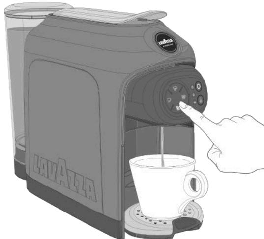
**!** Quando viene selezionata un'erogazione la macchina attiva l'elettropompa dell'acqua per 7 secondi.
