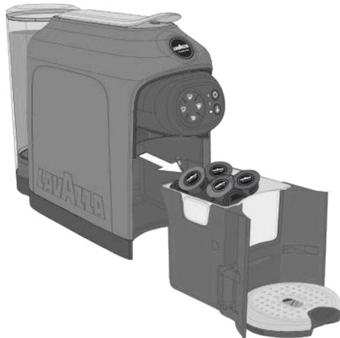
**i** Estrahendo il cassetto per più di 5 secondi, la macchina azzererà il conteggio delle capsule inserite.
