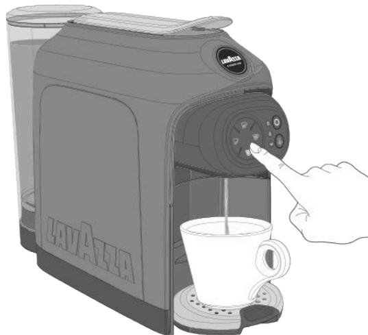
**!** Quand on sélectionne une distribution, la machine active l'électropompe de l'eau pendant 7 secondes.
