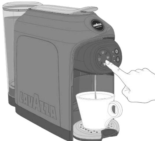
**!** Cuando se selecciona una erogación, la máquina activa la electrobomba del agua por 7 segundos.
