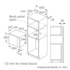
min. 300 min. 18 362<sup>+3</sup> min. 560<sup>+6</sup> Back panel open
