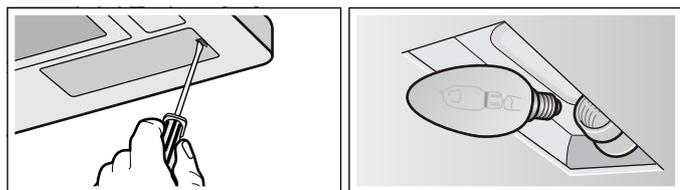
3. Remettez le couvercle de l'ampoule en place.
