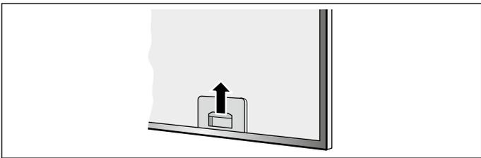
1. Ouvrez le verrouillage du filtre métallique à graisse et enlevez le filtre de sa fixation.
