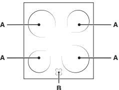
B. Piloto de calor: indica que la temperatura de la zona de cocción correspondiente es mayor que 60°C, aún cuando el elemento esté apagado pero todavía caliente.
