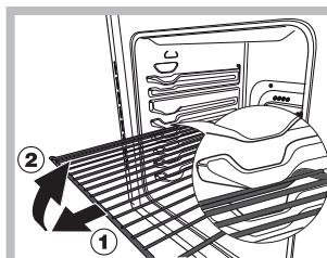
**ATENÇÃO!** O forno está equipado com um sistema de bloqueio das grelhas que permite retirá-las sem que estas ressaiam do forno(1). Para retirar completamente as grelhas, tal como indicado no desenho, basta levantá-las, segurando-as pela parte da frente, e puxá-las (2).
