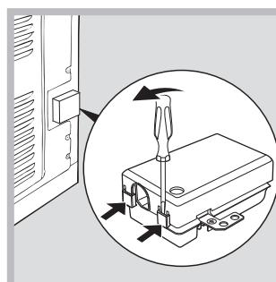
1. Abra a placa terminal inserindo uma chave de fendas nas abas laterais da tampa. Utilize a chave de fendas como alavanca, empurrando-a para baixo para abrir a tampa (ver diagrama).
