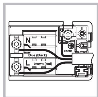
2. Desserrer la vis de serrage du câble et la déposer, au moyen d'un tournevis utilisé comme un levier (cf. figure).
