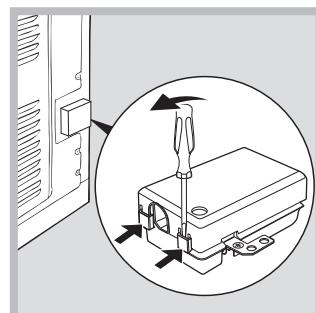
1. Ouvrir le bornier en insérant un tournevis dans les languettes latérales du couvercle. Appuyer sur le tournevis comme sur un levier pour ouvrir le couvercle (cf. schéma).
