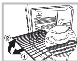
**ATENCIÓN!** El horno no está dotado de un sistema de bloqueo de las parrillas que permite quitarlas sin que sobresalgan del horno(1). Para quitar completamente las parrillas, como se indica en el dibujo, es suficiente levantarlas cogiéndolas de la parte delantera y tirar (2).
