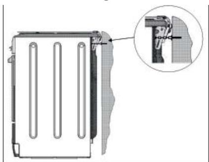
! Para impedir la inclinación accidental del aparato, por ejemplo en caso de que un niño intente trepar la puerta del horno, es NECESARIO instalar la ca-
