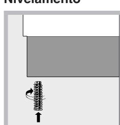
Se for necessário nivelar o aparelho, parafusar os pés\* de regulação nos específicos lugares colocados nos cantos na base do fogão (ver figura).
