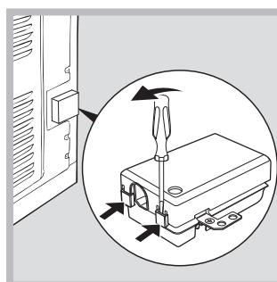
1. Abrir el tablero de terminales insertando un destornillador en las lengüetas laterales de la tapa. Hacer palanca con el destornillador empujando hacia abajo para abrir la tapa (ver el diagrama).
