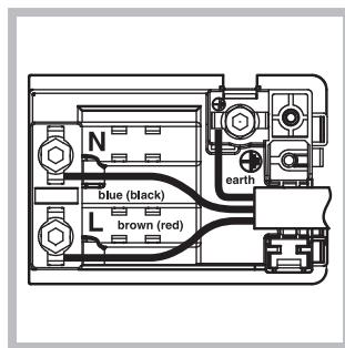
2. Aflojar el tornillo de fijación del cable y quitarlo haciendo palanca con un destornillador (ver la figura).
