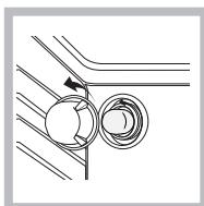
2. Desenrosque a lâmpada e troque-a por outra análoga: potência 15 W, engate E 14. Monte novamente a tampa, preste atenção para colocar correctamente a guarnição (veja a figura).
