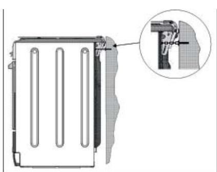
! Pour éviter le basculement de l'appareil, par exemple si un enfant s'accroche à la porte du four, la chaîne de sécurité DOIT être installée !
