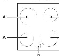
B. Indicador luminoso de calor: indica que a temperatura da zona de cozedura correspondente é superior aos 60°C, mesmo no caso em que o elemento esteja desligado mas ainda quente.
